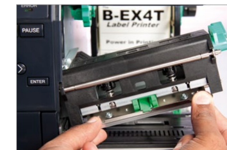
A cabeça de Impressão de fácil substituição (clip-on) reduz o tempo de manutenção ao mínimo.
